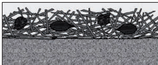
Application non appropriée d'un mulch fibres longues
