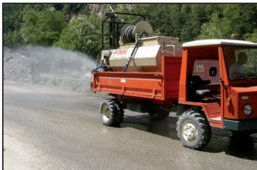
Dispositif pour abattage poussière monté sur hydroseeder
