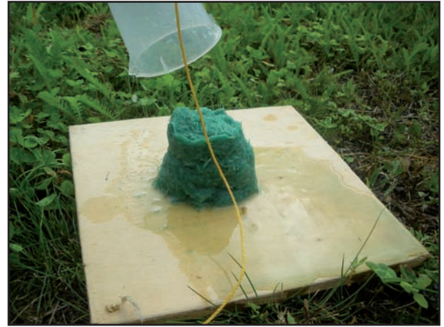
Test 2 : Mélange trop compact – Ajouter de l'eau ou du fixateur fluidifiant type VEGESTAB
