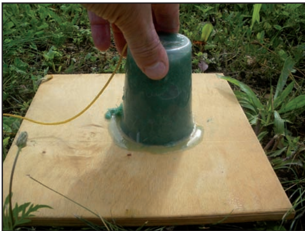
Test 3 : Mélange conforme – L'eau ruisselle peu et bonne cohésion du mulch et des fixateurs
