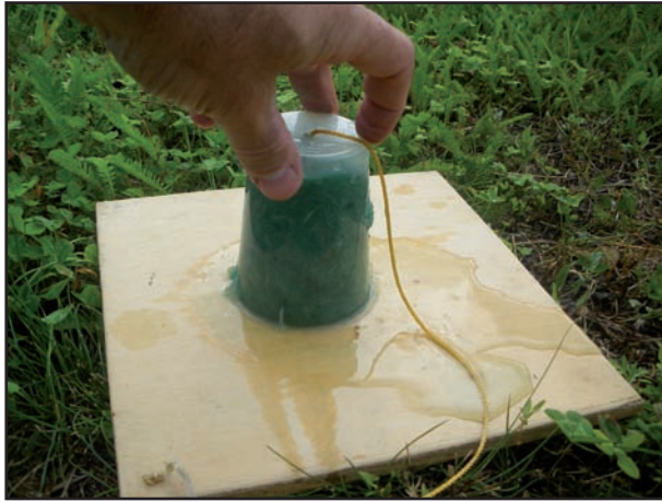
Test 2 : Mélange trop compact – Ajouter de l'eau ou du fixateur fluidifiant type VEGESTAB
