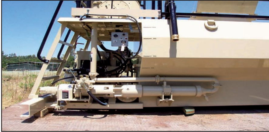
Pompe à rotor excentré montée sur un hydroseeder FINN T120 PC
