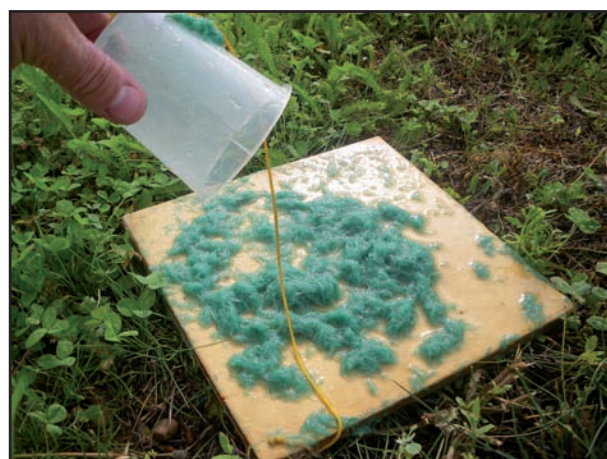
Test 1 : Mélange trop fluide – Ajouter de la fibre ou du fixateur
