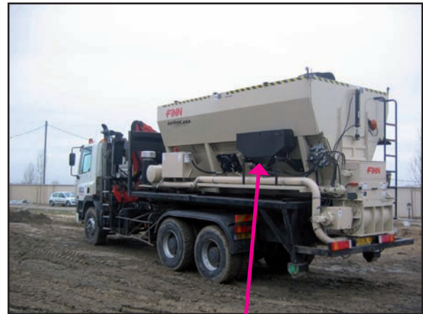
Traitement type Terraseeding avec Bark Blower modèle 1216 équipé d'un système d'injection de semences
