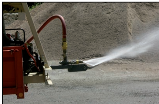
Dispositif pour abattage poussière monté sur hydroseeder
