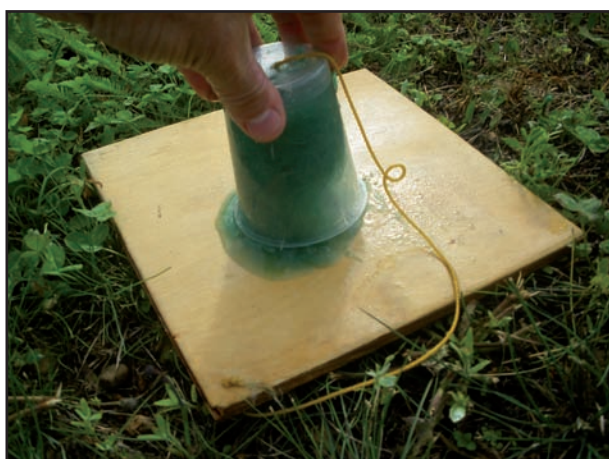
Test 1 : Mélange trop fluide – Ajouter de la fibre ou du fixateur
