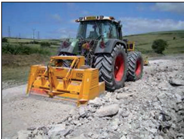
Préparation de sol par concassage
