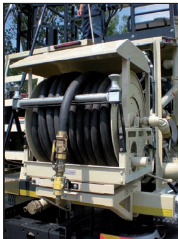
Enrouleur hydraulique orientable de tuyau semi-rigide (60 ml)
