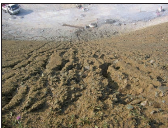
Dosage de mulch 150 bottest/ha X 1.2 = 180 bt/ha (à gauche) Dosage de mulch 150 bt/ha (à droite)
