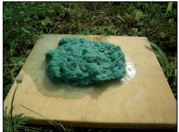
Test 3 : Mélange conforme – L'eau ruisselle peu et bonne cohésion du mulch et des fixateurs
